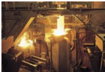
Оборудование ESU в сталеплавильном цеху БГХ ESR in the BGH steel mill
